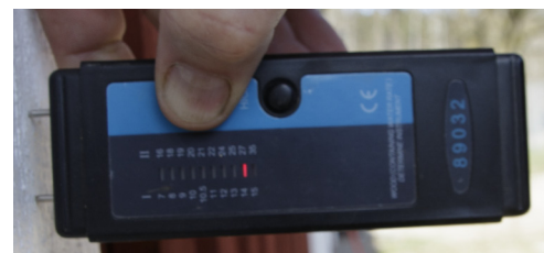
Fuktkvotsmätare. Fuktigheten i denna bräda är 14%, och bör inte överstiga 17%.
