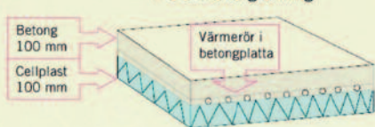
Figur 2: Vanliga respektive energieffektiva och komfortabla golvvärmekonstruktioner vid platta på mark.
