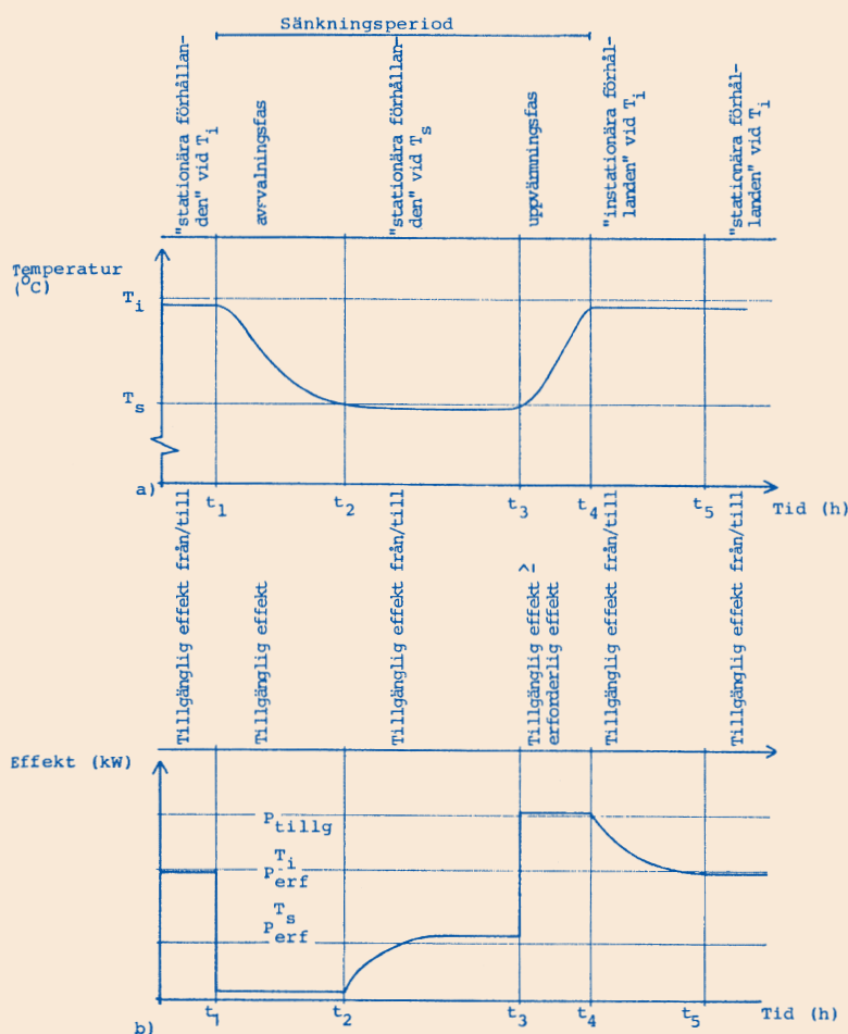
Figur 1: Principiella samband mellan temperatur, effekt och tid vid periodvisa temperatursänkningar, Harrysson (1981, 1985). Konstant utetemperatur har därvid förutsatts. Byggnaden antas ha direktverkande termostatreglerade elradiatorer. Sänkningen är tänkt vara reglerad med ett tidur och kontaktorstyrd rumstermostat. a (överst): Temperatur - tid. b: Effekt - tid.
